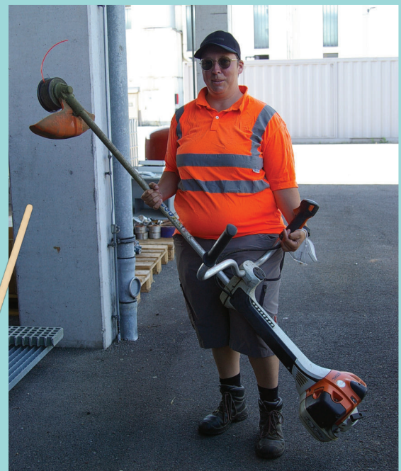
Das ist ein Freischneider. Damit schneidet man den Rasen.
